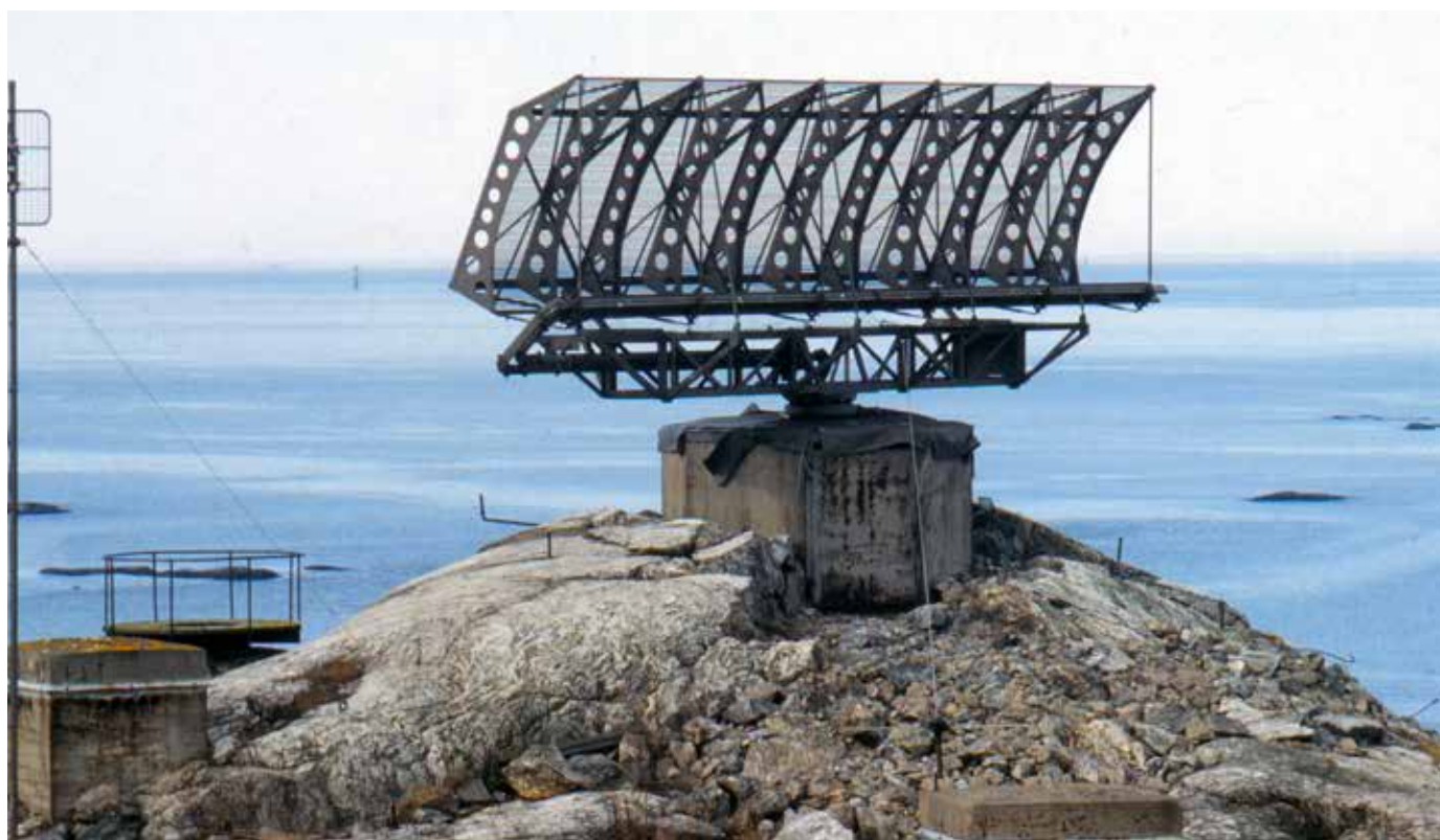
Den nyuppsatta 8 m breda radarantennen vid Traditionsrummet är likadan som den som stod här på Känsö
